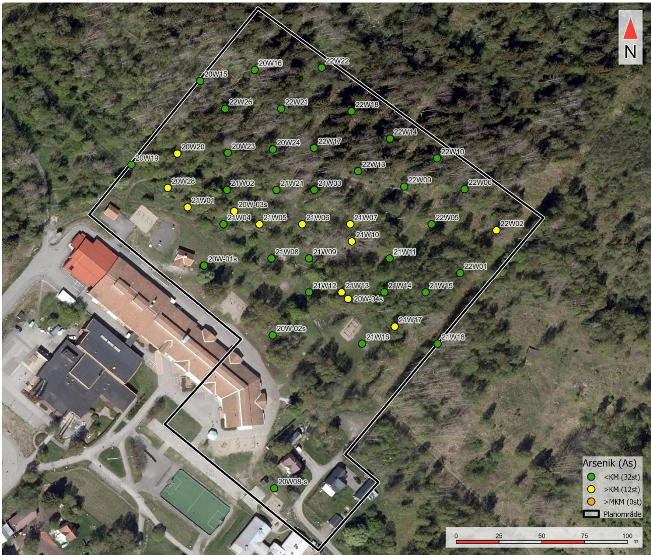
Figur 7: Resultatkarta som visar arsenikhalter inom Timrå kommuns planområde för etablering av förskoleverksamhet. Området innefattar punkter för undersökningarna 2020, 2021a samt 2022. Figuren bifogas även som extern karta N302.
