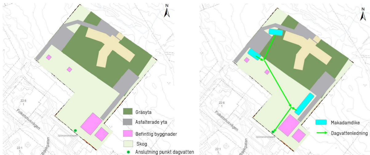
Förslag på avdelning av dagvatten i stråk med inbyggd möjlighet till magasinering, Sweco.
