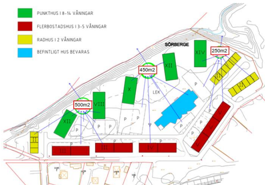
Figur 14. Skiss med förslag på avledning av dagvatten inom området. Mindre blå pilar redovisar vilka ytor som föreslås stå i förbindelse via svackdiken till respektive utjämningsanläggning.
